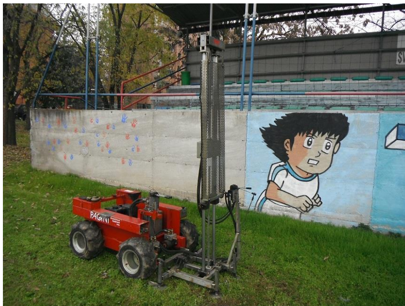
Figura 7 esecuzione delle prove penetrometriche dinamiche nel sito di indagine
