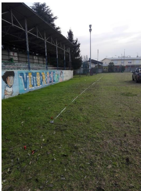
Figura 8 esecuzione della prova MASW nell'area di indagine
